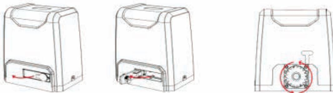
Para poner el motor en modo manual, inserte la llave y abra la barra de liberación manual como se muestra.
