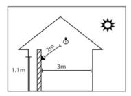
Instale el dispositivo en interiores al menos a 3 metros (10 pies) de distancia de cualquier ventana, y a 2 metros (6.5 pies) de cualquier fuente de luz.
