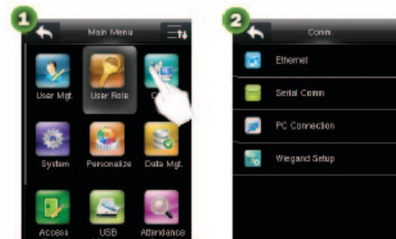
Establezca los parámetros para la comunicación entre el dispositivo y una PC, incluyendo la dirección IP, puerta de entrada, máscara subred, velocidad de transmisión, número de dispositivo y contraseña de conexión.
