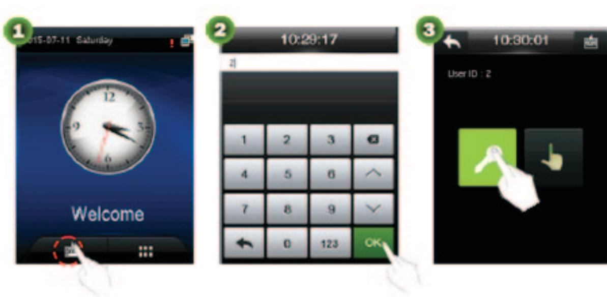
4. En la interface de la pantalla, ingrese la contraseña y de clic en **OK**. Si la verificación es exitosa, el dispositivo reproducirá una voz diciendo "Gracias" y "Acceso Correcto" desplegado en la pantalla. Si la verificación falla, el dispositivo reproducirá una voz diciendo "Por favor intente de nuevo" y "Acceso denegado" desplegado en la pantalla.
