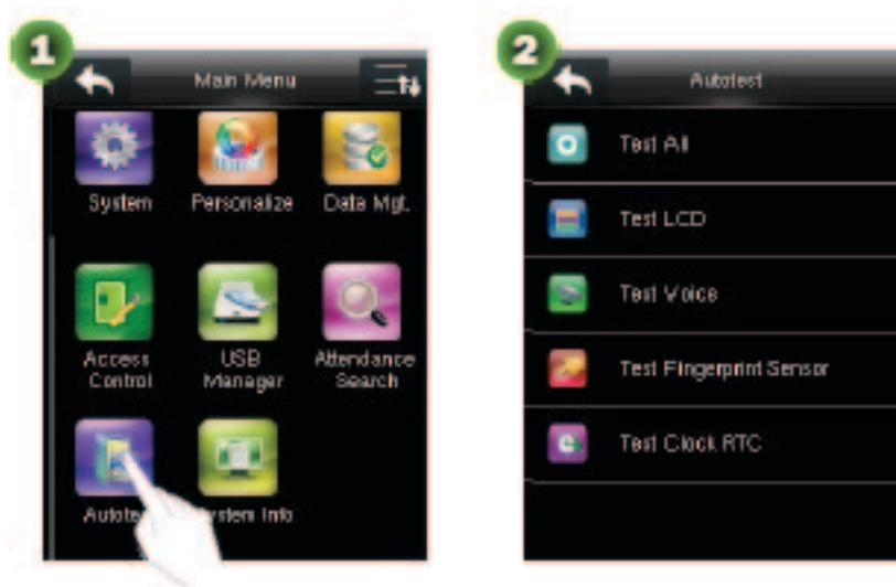
**Prueba de Todo:** Prueba el LCD, voz, sensor de huella digital★ y RTC. Durante la prueba, haga clic en la pantalla para continuar con la siguiente prueba o haga clic en
