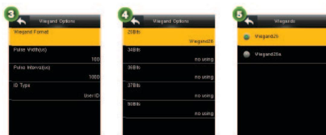
**Formato Wiegand:** El usuario puede escoger entre los formatos Wiegand integrados: Wiegand 26, Wiegand 26a, Wiegand 34, Wiegand 34a, Wiegand 36, Wiegand 36a, Wiegand 37, Wiegand 37a y Wiegand 50.
